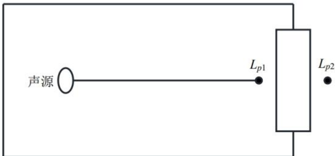
图 4.2-5 室内声源等效为室外声源图例
