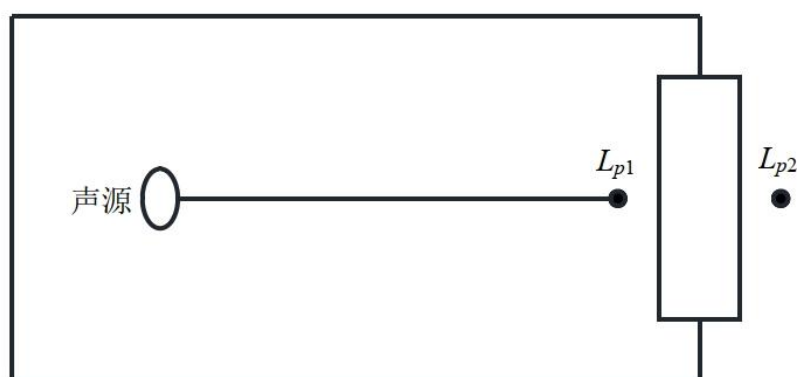
图 4-2 室内声源等效为室外声源示意图
