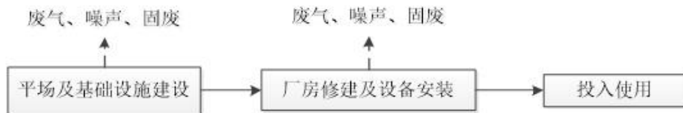
图 2-2 施工期工艺流程及排污节点图
