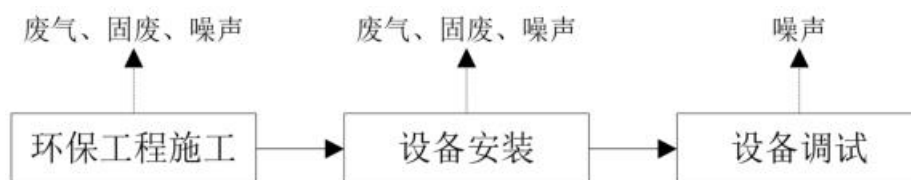
图 2-2 施工期工艺流程及产污环节示意图
