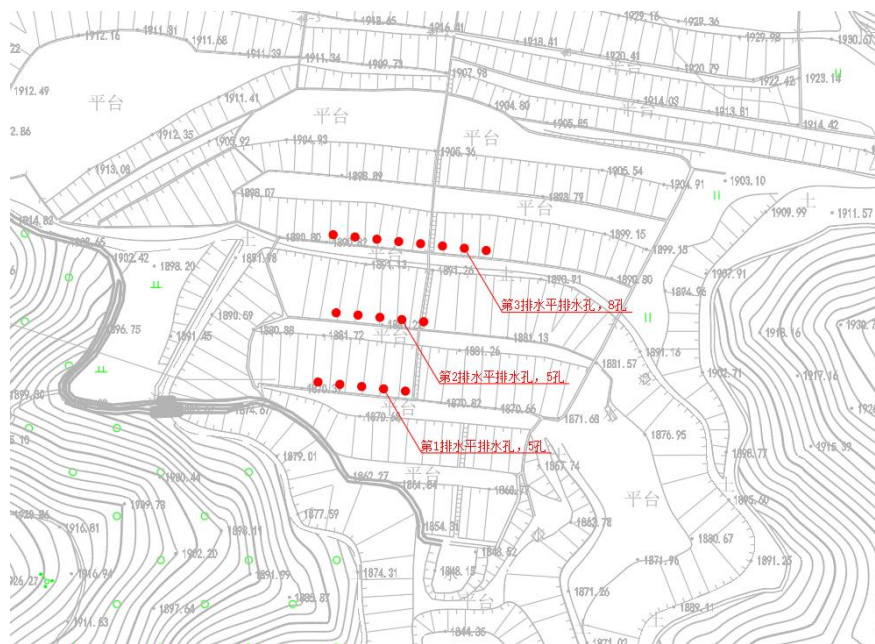
图 2-7 增设水平排渗孔平面布置图
