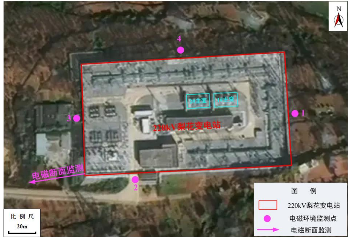
图 2 220kV 梨花变电站监测布点示意图
