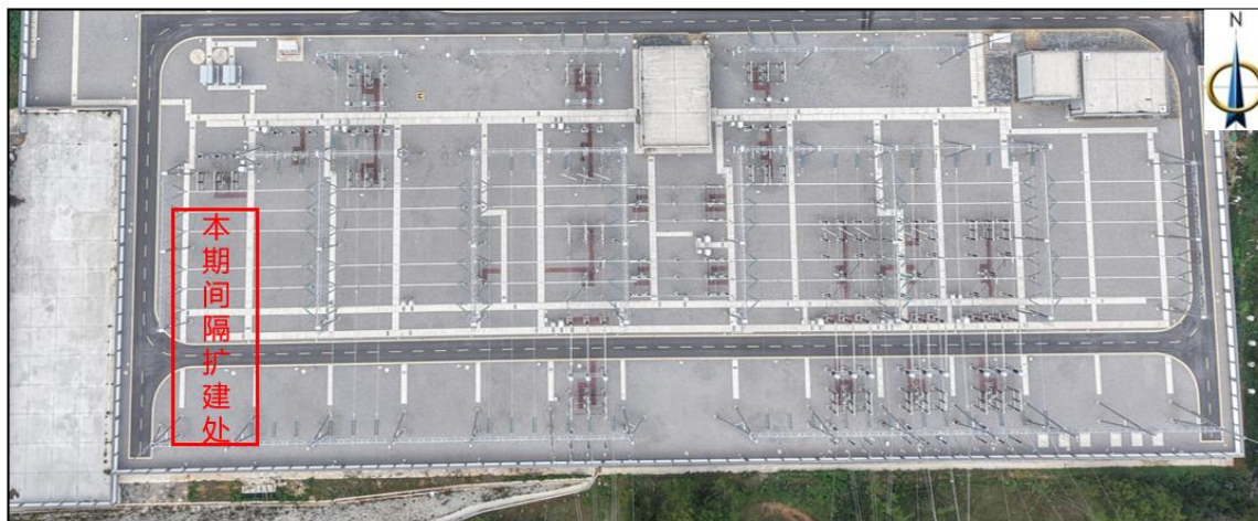
图 4 220kV 安丰变电站 220kV 配电装置区平面布置图
