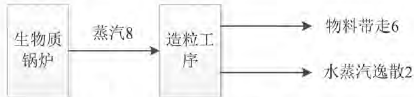
图 2-1 厂区蒸汽平衡图 (t/d)
